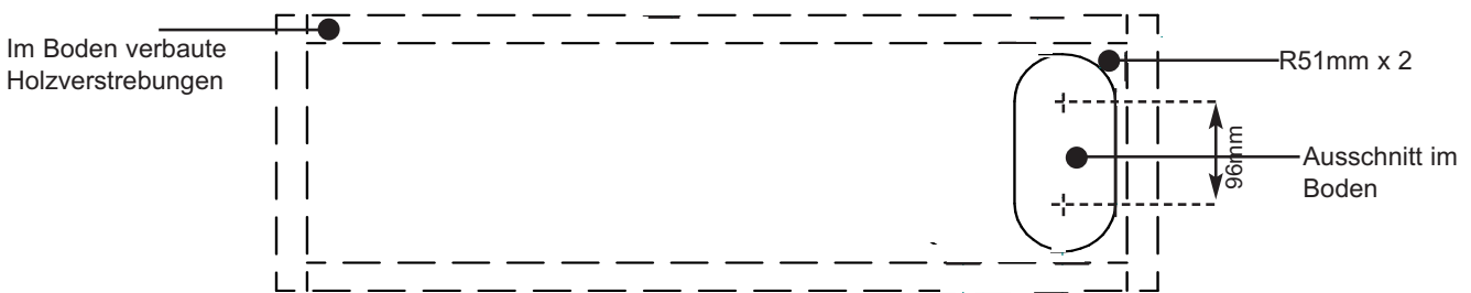
Abb. 17 Befestigung des Raumluftheizgeräts (Grundriss)
