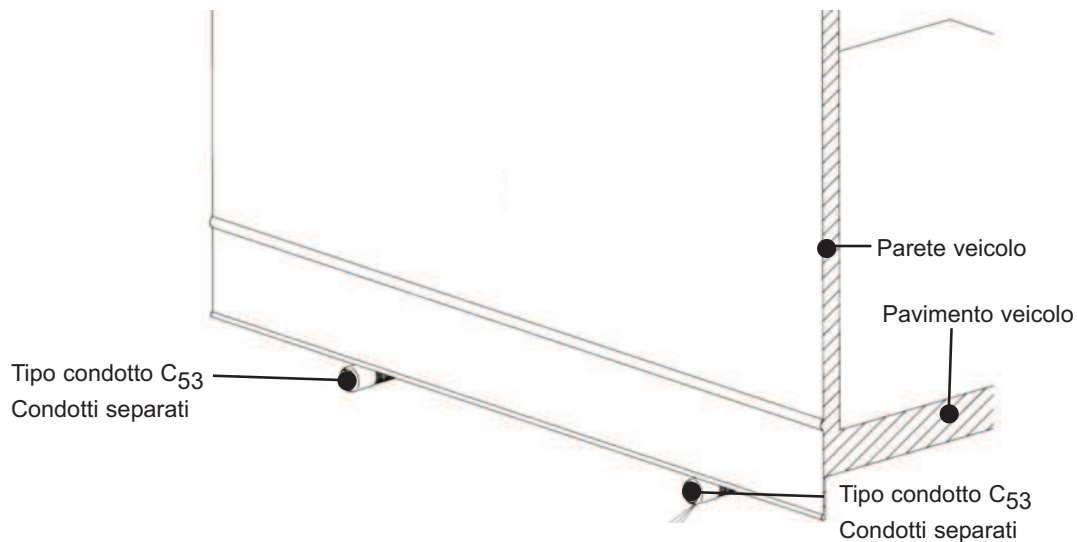
Figura 41 – Tipo di condotto per l'installazione standard C 53
