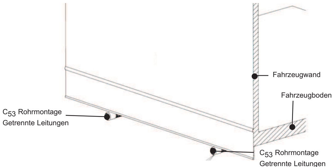
Abb. 41 Rohrmontageart für Standardinstallation C 53
