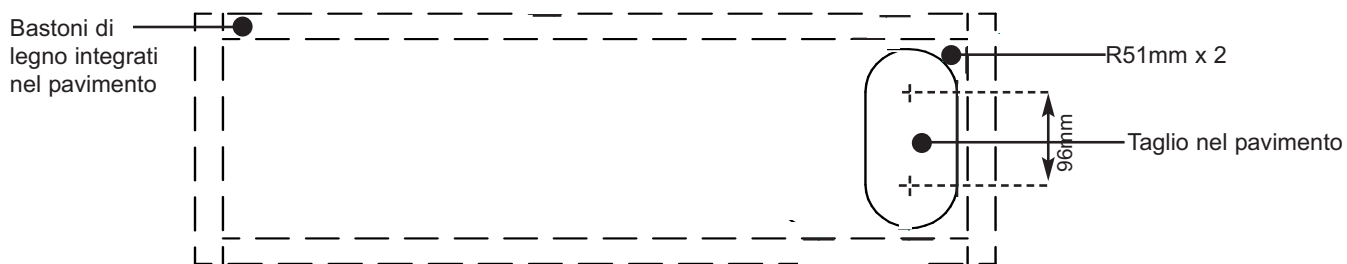
Figura 17 – Fissaggio della stufa (vista in pianta)
