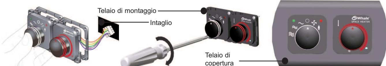
Figura 15 – Inserimento del pannello di controllo
