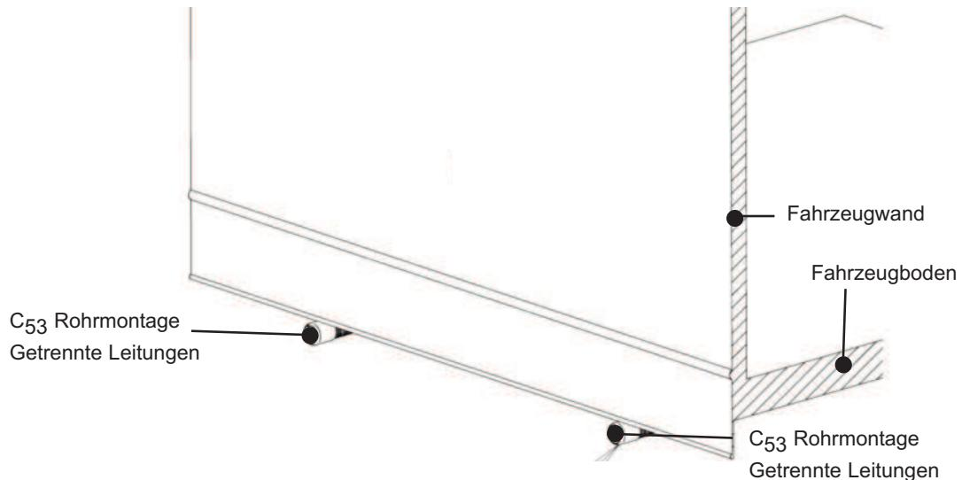
Abb. 25 Rohrmontageart für Standardinstallation C<sub>53</sub>
