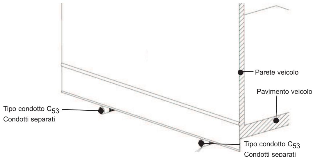
Figura 25 – Tipo di condotto per l'installazione standard C53
